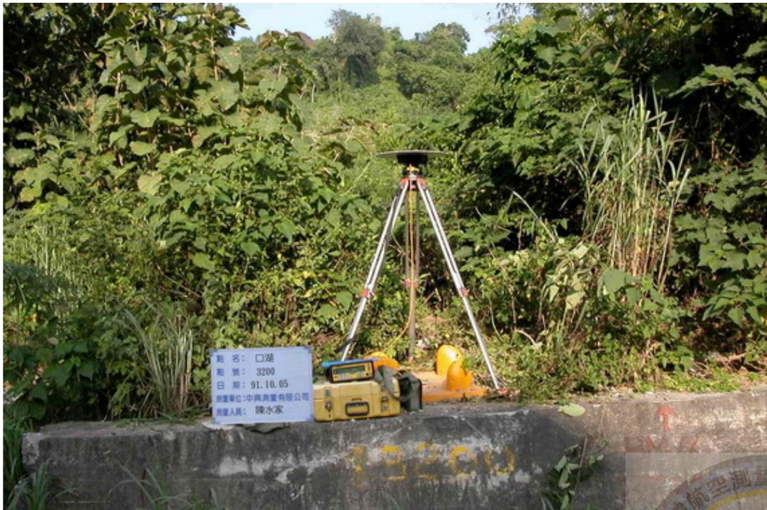
圖十 內政部地政司衛星測量中心之水準點編號 3200，點位高程為 88.68 公尺，如照片顯示該水準點鄰近地況植被覆蓋密布。
