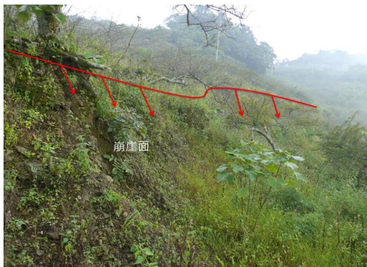
圖 8 此為圖 6(B)處於現地上呈現梅樹園坡面有一明顯高差，顯示崩崖於梅樹園發育的情形
