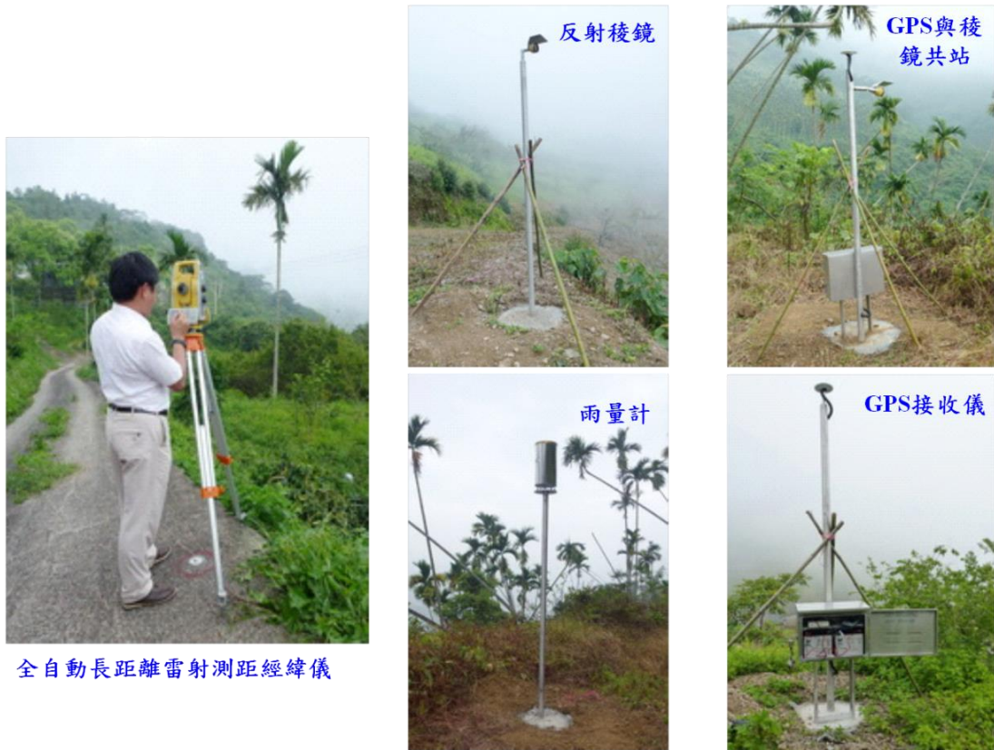
圖 10 經濟部中央地質調查所監測大規模崩塌之簡易監測儀器
