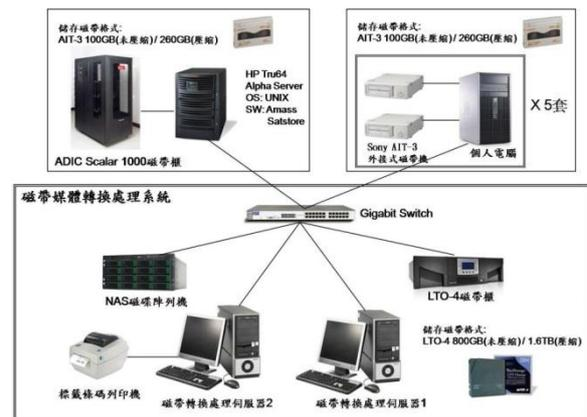
圖 7 磁帶資料轉換系統
