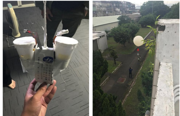
圖 4 2017 年 11 月 9 日早上 8 點 Windsond 與 RS41 平行比對儀器擺放方式
