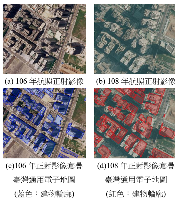
圖 9 房屋高差移位示意圖
