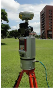
圖 1 地面掃描儀上方裝置 GPS 天線
