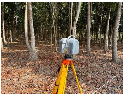
圖 3 Trimble TX8 地面光達 (本研究拍攝)
