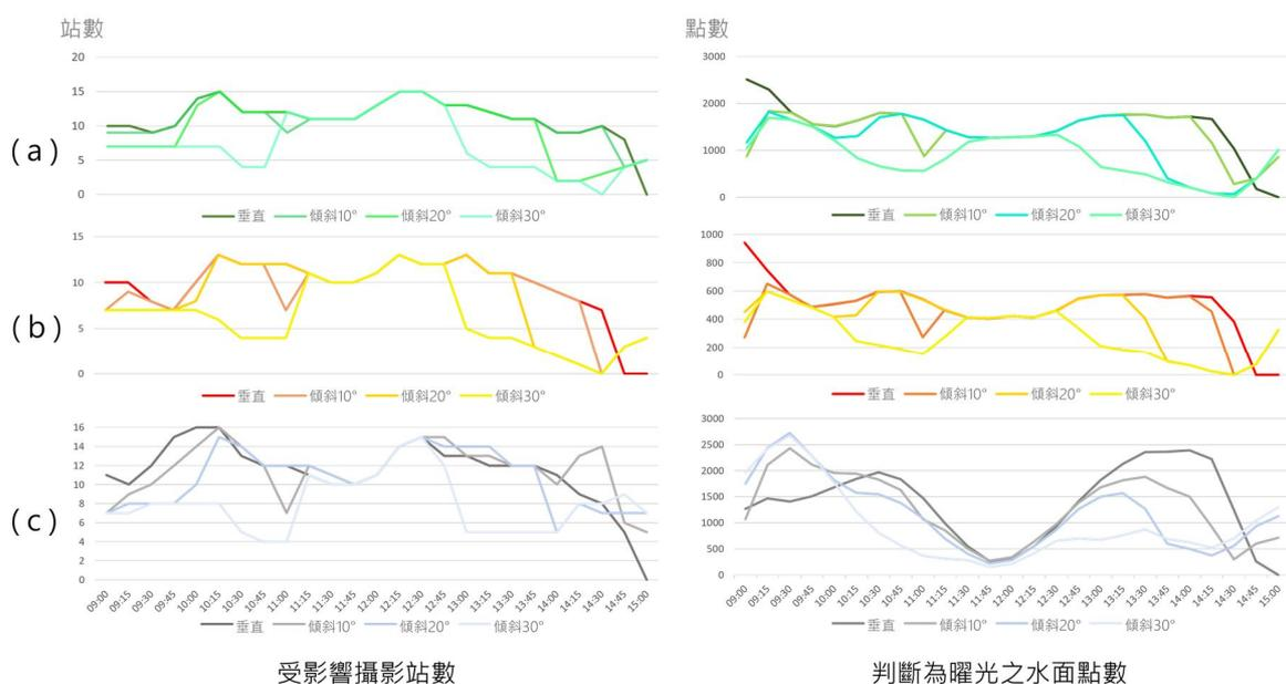
圖 9 西北-東南航帶方向設定下，(a) 曜光角 3.5 度、(b) 曜光角 2 度、(c) 光線向量角度差之判斷成果於不同鏡頭傾斜角度下，受曜光影響攝影站數與被判斷為曜光之水面點數
