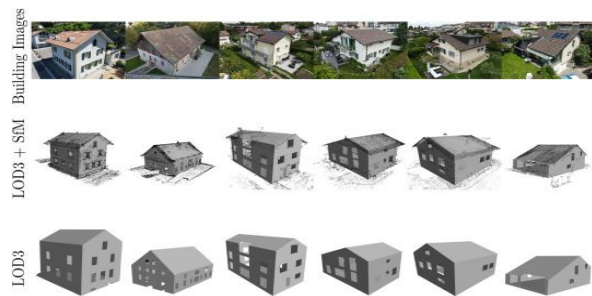
圖 1 結合點雲平面擬合與語意分割技術所建置之 LoD3 建物模型 (Pantoja-Rosero et al. , 2022)
